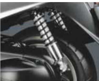
Zwei Dämpfer mit Dual-Rate-Federn, fünffach verstellbarer Vorspannung und 115-mm-Federweg nehmen die Hinterradschwinge auf.
