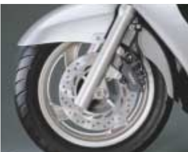
Für kontrollierte Verzögerung auch durch weniger erfahrene Fahrer: das hydraulische CBS-Bremssystem.
